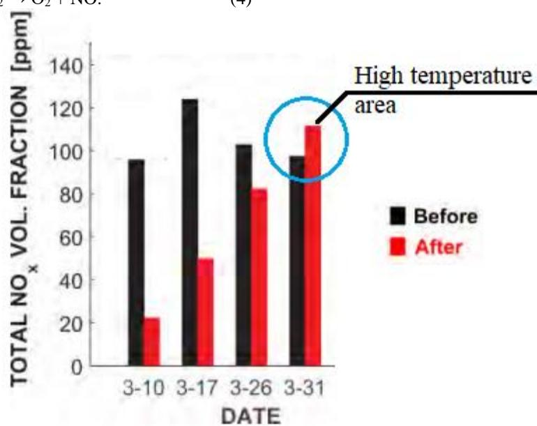
Рис. 1. Зона збільшення викидів оксидів азоту при збільшенні температури
