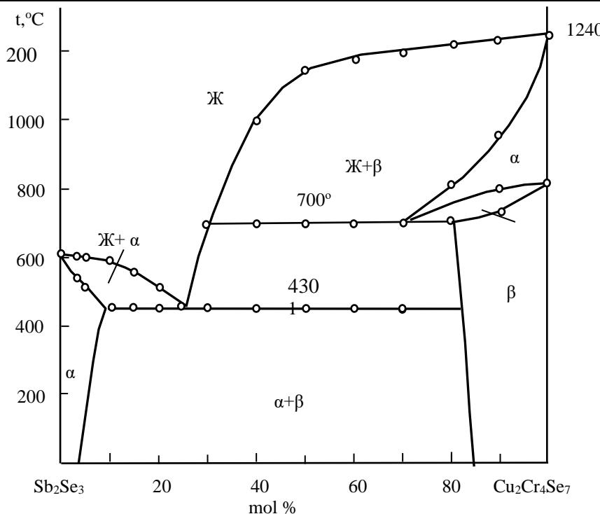
Рис. 2. Т-х фазовая диаграмма системы Sb<sub>2</sub>Se<sub>3</sub>-Cu<sub>2</sub>Cr<sub>4</sub>Se<sub>7</sub>.
