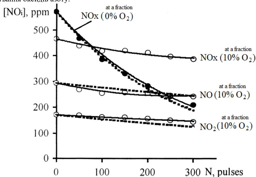
Рис. 2. Вплив концентрації  $O_2$  та кількості розрядів на руйнування оксидів азоту
