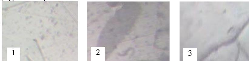
Рис. 1. Микроструктуры сплавов системы  $Sb_2Se_3-Cu_2Cr_4Se_7$ .
