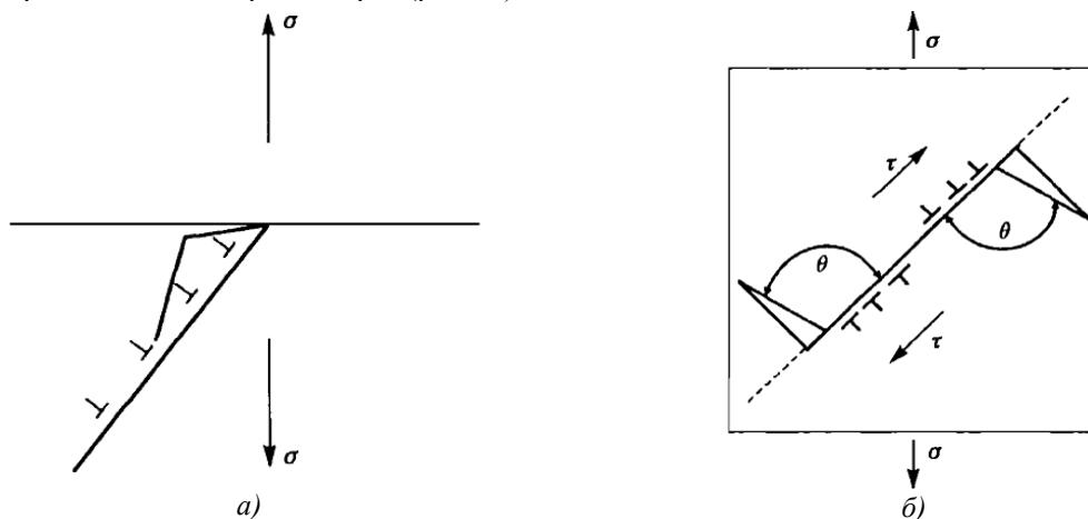
Рисунок 4. Модель Баллафа-Гилмана (а); модель Орована-Стро (б).
