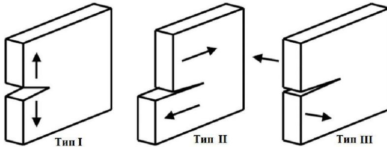
Рисунок 8. Типы раскрытия трещин [14].
