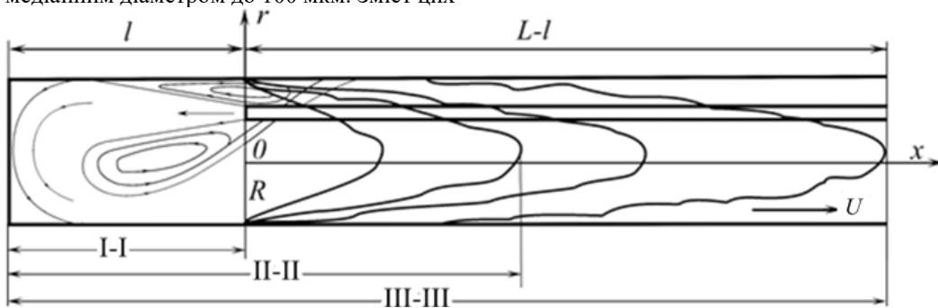
*U – швидкість вентиляційного потоку; L – довжина виробки, м; R – радіус виробки, м; l – довжина ПГХ, м; I-I, II-II, III-III – положення ПГХ по відношенню до вибою*
