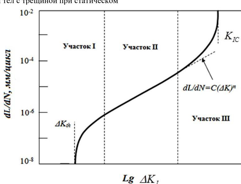
Рисунок 10. Схема диаграммы  $dL/dN - \Delta K_I$  [14].
