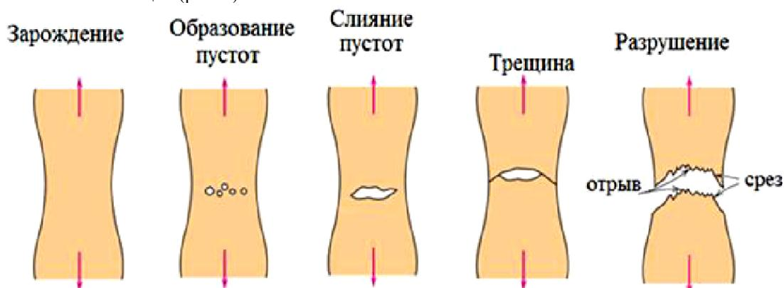
Рисунок 6. Эволюция умеренно вязкого разрушения цилиндрического образца [12].
