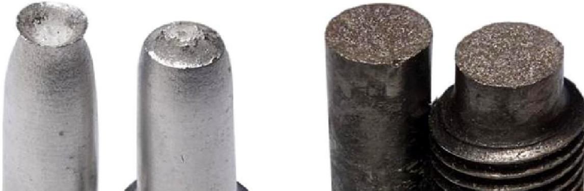
Вязкое разрушение типа чашечка и конус
