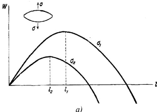
Рисунок 1. Зависимость  $W(l)$  по Гриффитсу; зависимость  $W(l)$  по Френкелю [3].
