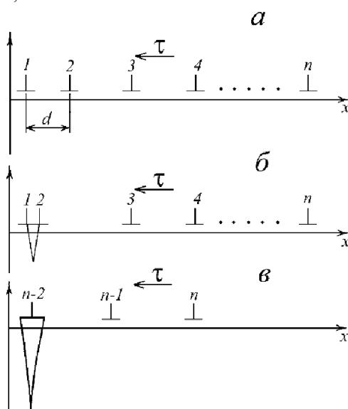
Рисунок 2. Схема зарождения микротрещины в модели Стро:
