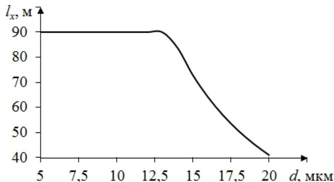
Рис. 2. Залежність відстані переносу частинок кварцу вентиляційним потоком за час  $t = 300$  с після закінчення активної фази розповсюдження продуктів детонації в тупиковій виробці
