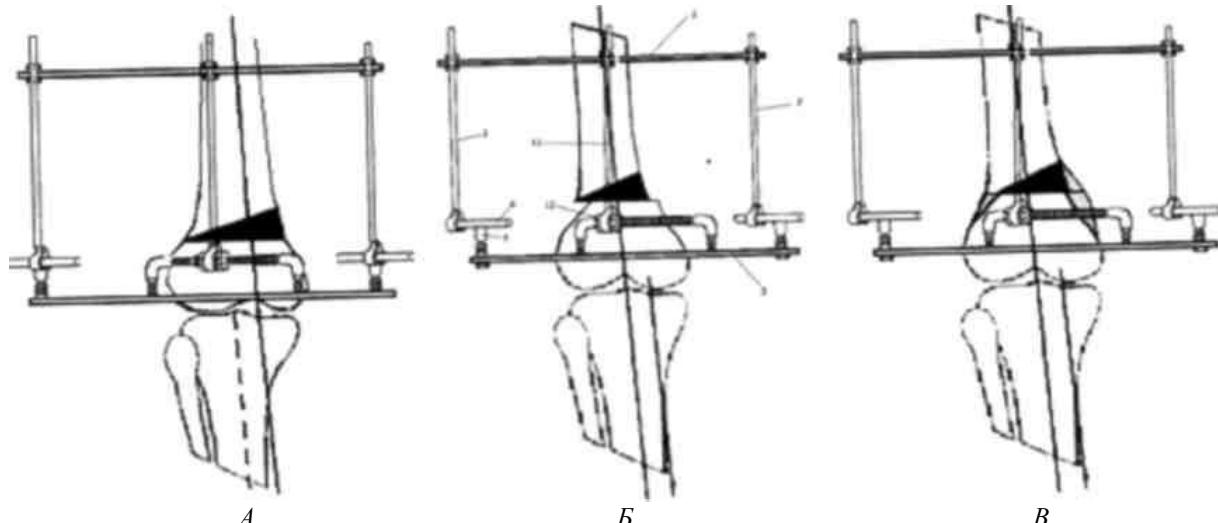
*Рис. 3. Аппарат с разработанными приставными узлами для исправления биомеханической оси конечности: А – после устранения деформации за счет формирования дистракционного костного регенерата, но со смещенной внутрь осью конечности; Б – после устранения деформации с перемещеннымproxимальным фрагментом бедренной кости и восстановленной осью конечности; В – окончательное формирование дистракционного клиновидного костного регенерата*
