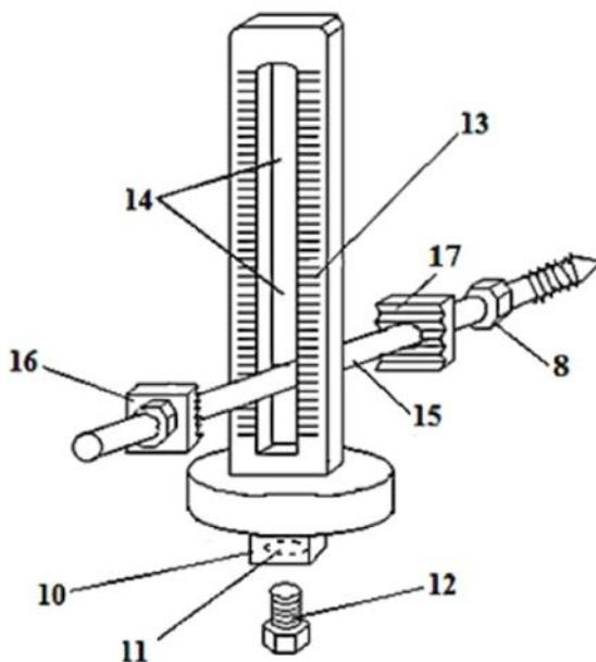
Рис. 3. Выносной стержнефиксатор.
