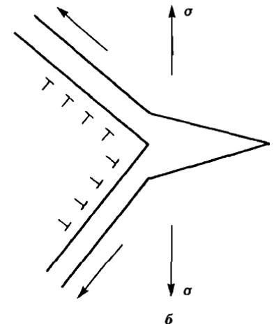
Модель Орована-Стро описывает образование трещин путем образования рядов дислокаций в результате полигонизации (рис. 4б).
