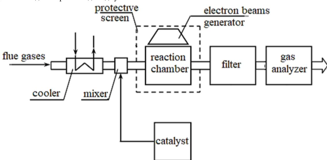
Рис. 3. Експериментальна установка дослідження електроімпульсної обробки димових газів
