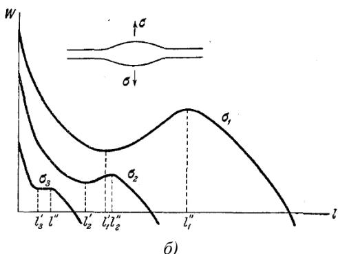
друг с другом, наступает катастрофическое удлинение трещины и разрушение.
