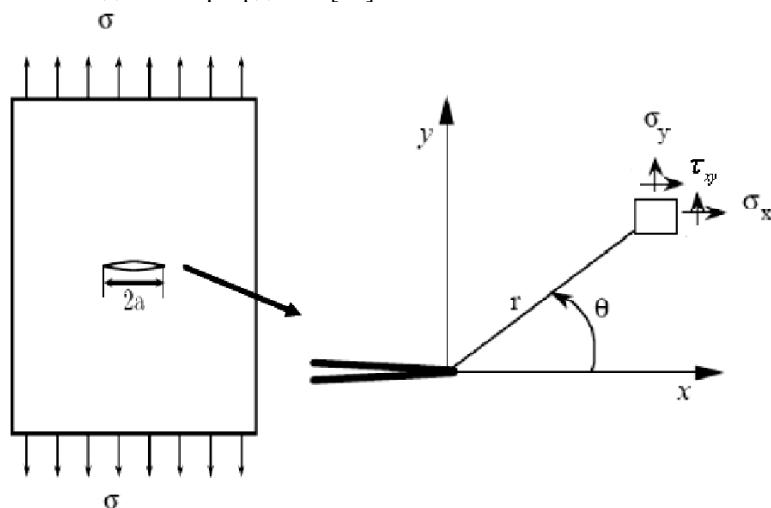
Рисунок 9. Напряженное состояние в вершине трещины [14].
