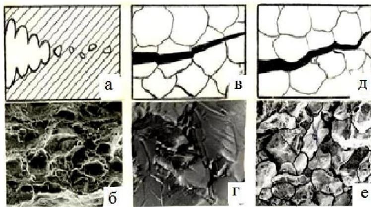
Рисунок 5. Механизм разрушения и соответствующий макрорельеф вязкого (а, б) и хрупкого (в – е) изломов; а, б – ямочное разрушение срезом; в, г – скол (транскристаллитное разрушение); д, е – межзёдальное (интеркристаллитное хрупкое разрушение) [12].
