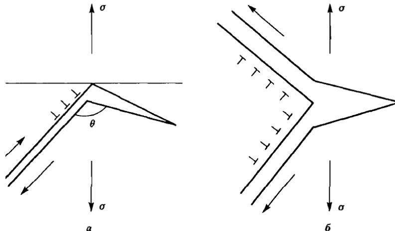
Рисунок 3. Модель Зинера-Стро-Петча (а); модель Коттрелла (б) [9].
