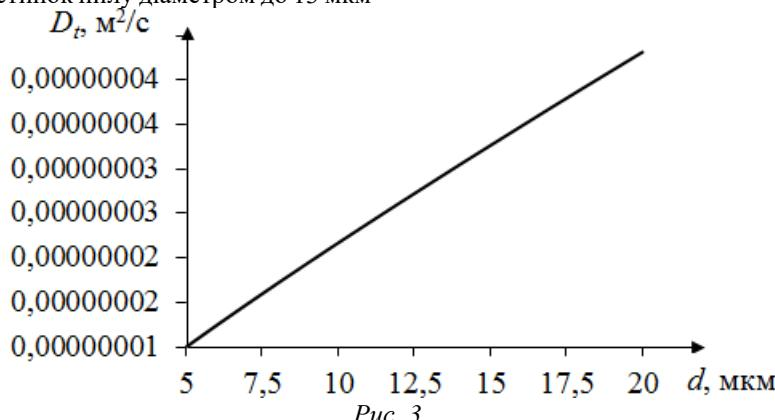
Залежність коефіцієнту турбулентної дифузії частинок кварцу від еквівалентного діаметру частинок
