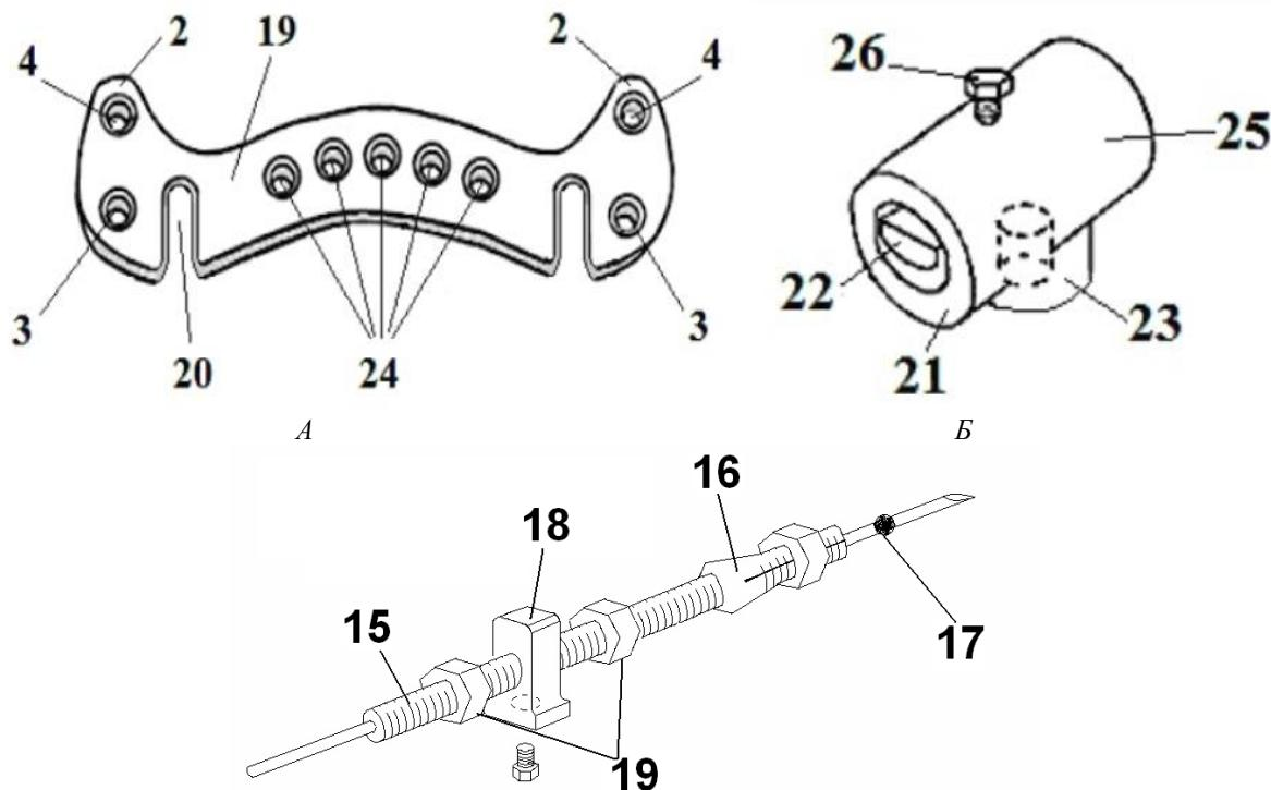
Рис. 2. Оригинальные узлы аппарата: А - съемная репонирующая опора аппарата для лечения оскольчатых переломов длинных трубчатых костей, Б - спицефиксатор для лечения оскольчатых переломов длинных трубчатых костей, В - спицефиксатор (патент №2271168).
