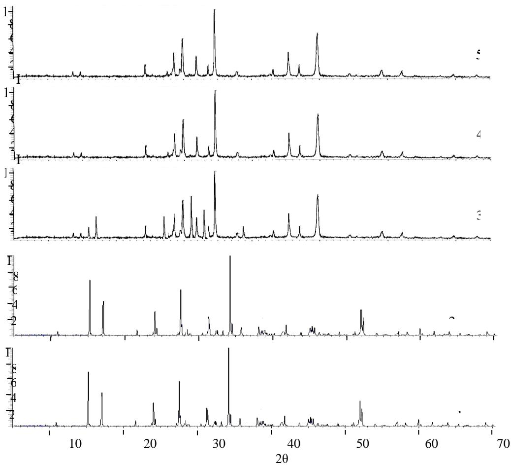
*Рис.1. Рентгеновские дифрактограммы сплавов системы  $Sb_2Se_3-Cu_2Cr_4Se_7$ .
